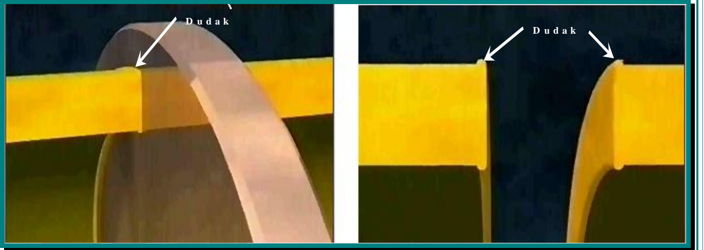
Şekil 4: Basıncılı ısıtma (yanaştırma) sırasında (sol) ve sonrasında boru ağızlarının yaptığı dudak
