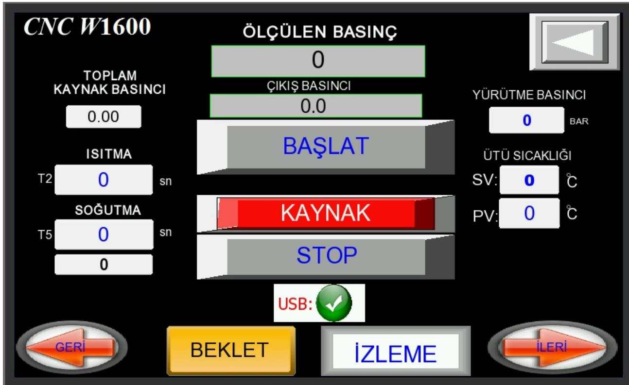
14-Isıtmaya başlamadan önce hareketli kelepçeler tuşuna basarak en başa alınır ve **BAŞLAT** tuşu ile boruların kaynak sıcaklığına çıkışma işlemine başlanır, basınçlı dudak yükseltme T1 süresi başlatılır.
