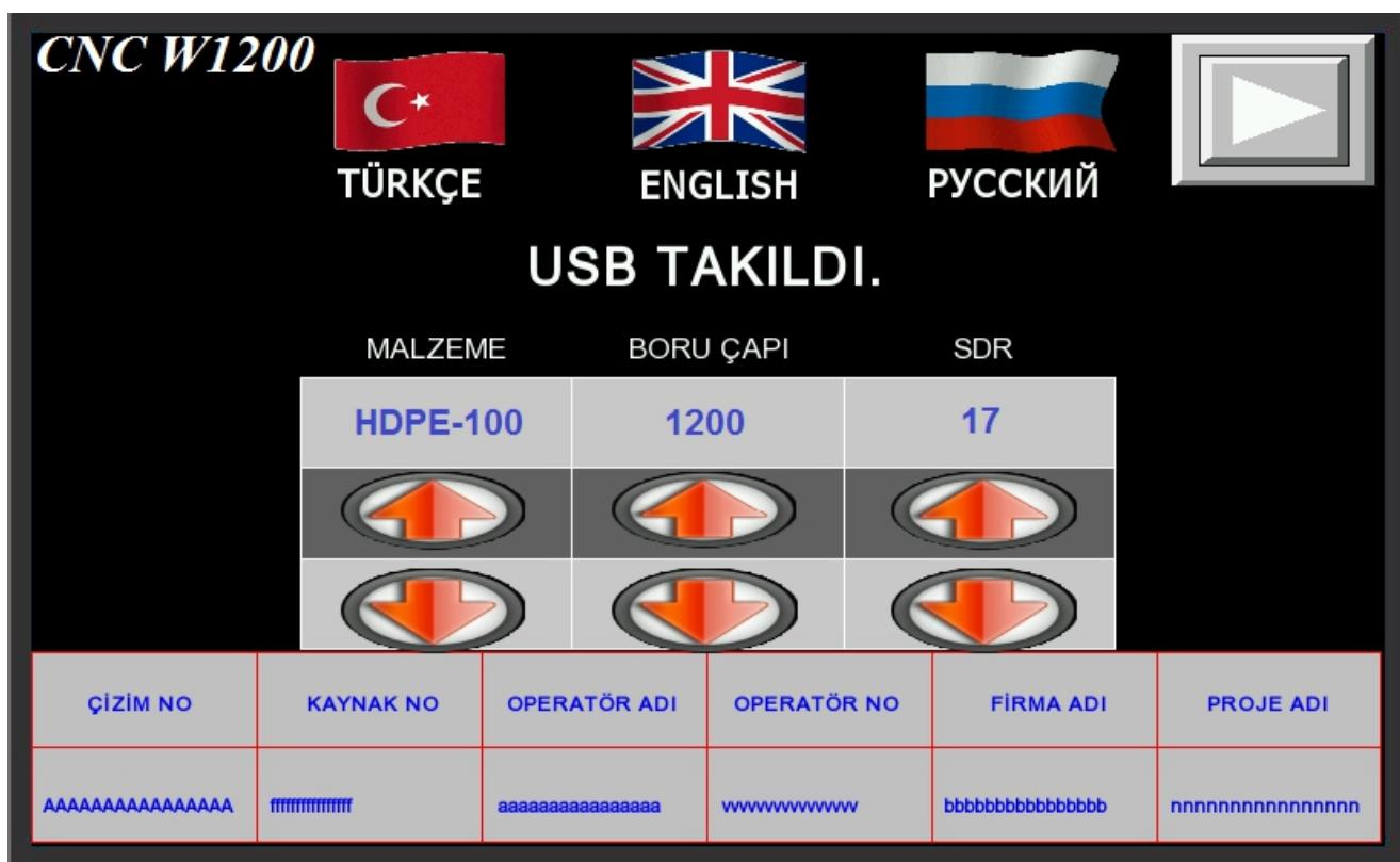
6-Çizim no,Kaynak no,operatör adı,operatör no, firma adı, proje adı alanları üzerine dokunurak çıkan klavye ekranından doldurulur. ENTER'a basılarak tuşu ile diğer ekrana geçilir.
