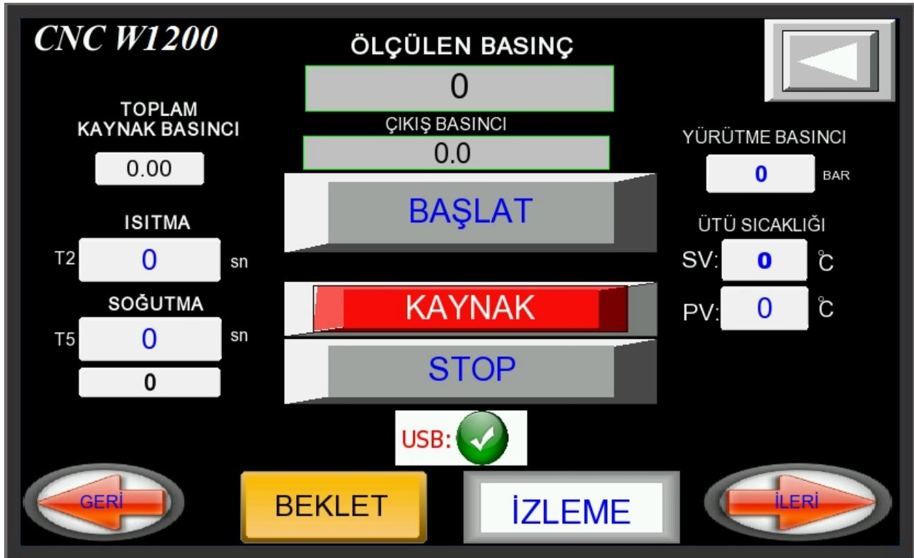
14-Isıtmaya başlamadan önce hareketli kelepçeler tuşuna basarak en başa alınır ve **BAŞLAT** tuşu ile boruların kaynak sıcaklığına çıkarma işlemine başlanır, basınçlı dudak yükseltme T1 süresi başlatılır.
