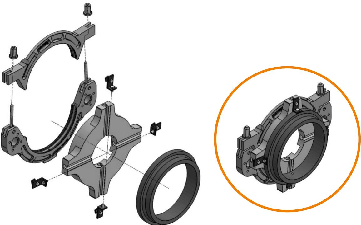
**Şekil 1.** Flanş adaptör paftasının kullanılması
